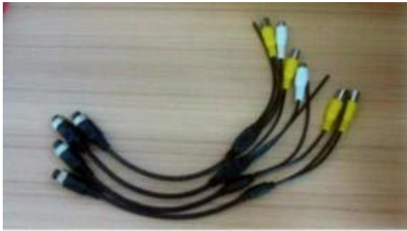
AV Input Cables
